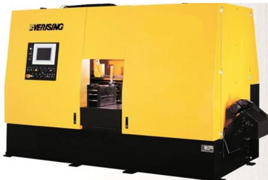
Двухколонные ленточнопильные станки разработаны специально для распиловки труднообрабатываемых сталей и сплавов полотнами с твердосплавным зубом для достижения максимальной производительности. Оснащены ЧПУ режимами резания
